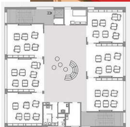
Unterrichtsgebäude mit offenen Klassenräumen und Lernmitte
